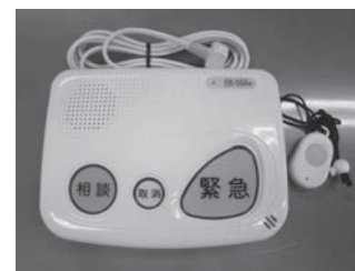
▲ 固定型緊急通報装置
