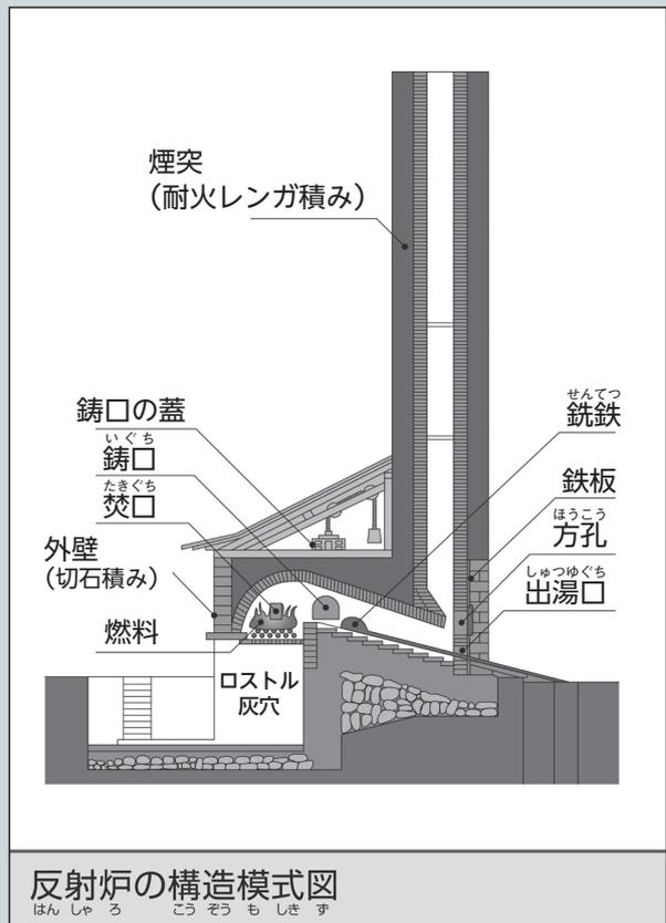
反射炉の構造模式図
